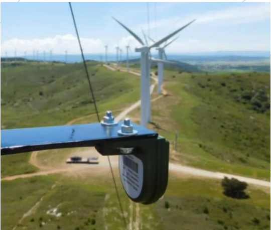
Micro à ultrason sur mât de mesure
