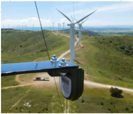
Micro à ultrason sur mât de mesure
